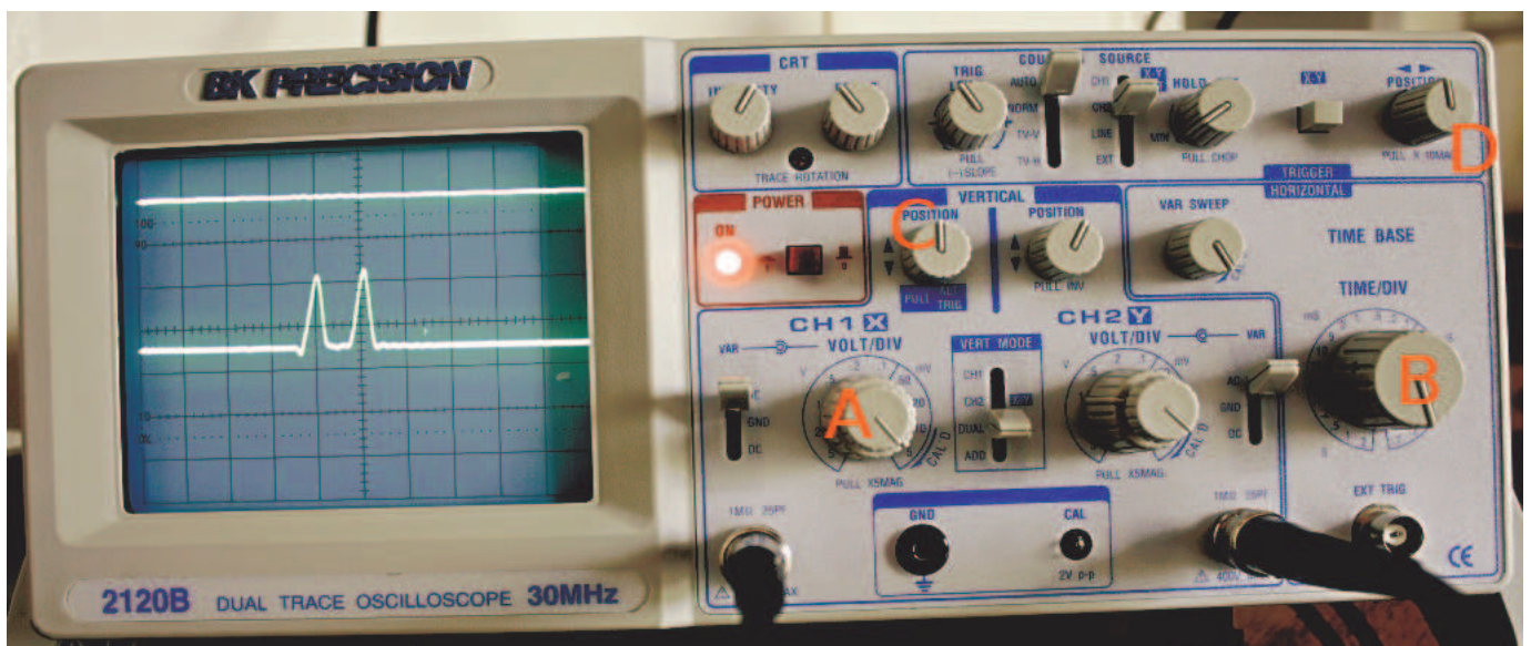
Rys. 2 Widok panelu oscyloskopu 2110B, gdzie: A - pokrętko czułości toru pomiarowego, B – pokrętko podstawy czasu, C - pokrętko przesuwu w pionie przebiegu dla kanału A, D – pokrętko przesuwu w poziomie przebiegu dla kanału A.
